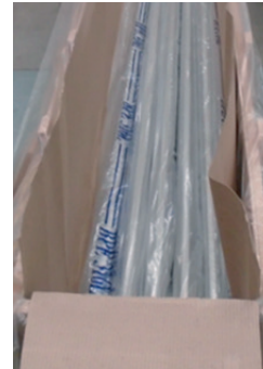
После упаковки трубы в мешок из ПВХ помещают в деревянный ящик Po zabalení trubek do PVC sáčku vloženo do dřevěné bedny
